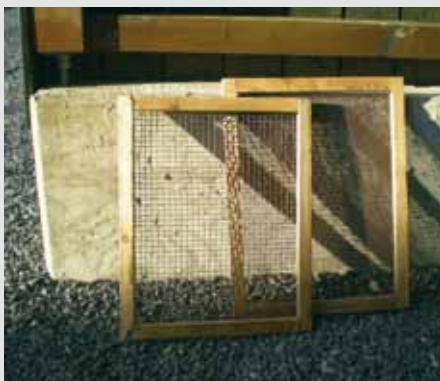
6. Siebe mit verschiedenen Gitterweiten für unterschiedliche Korngrößen
