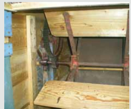
8. Windrad mit fünf Schaufeln im Inneren der Maschine
