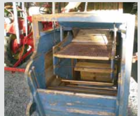
5. Vorrichtung zum Rütteln des gedroschenen Materials, wird von unten mit Luft durchströmt
