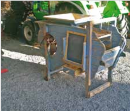
2. Gegenüberliegende Seite mit Handkurbel und Halter für Siebe verschiedener Gitterweiten
