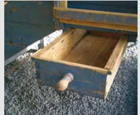
4. Schublade zum Auffangen des vom Spreu getrennten Kornes
