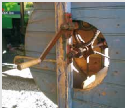
7. Handkurbel zum Antrieb der Windfege mit Rüttelvorrichtung und Windrad
