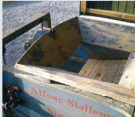
3. Einfülltrichter für das Befüllen der Windfege mit zuvor gedroschenem Material
